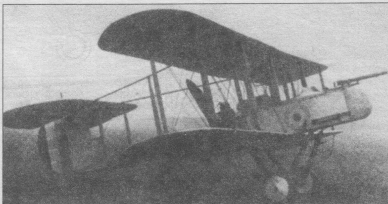
«Виккерс FV.9» с модифицированной гондолой, вооруженный пулеметом «Льюис».
