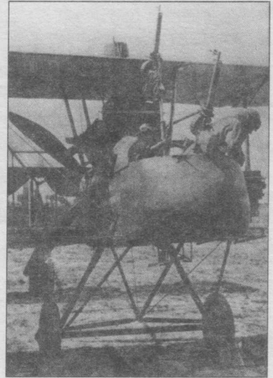
FE.2b из 20-й эскадрильи, 1916 год. Видно вооружение в виде трех пулеметов «Льюис» и четырехлопастный винт.
