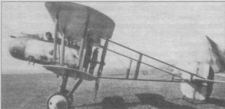
«Виккерс FB.12» с двигателем «Ле-Рон» мощностью 58 кВт.
